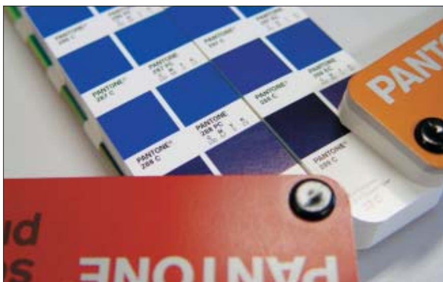
SWOP contre Eurostandard. Sur cette image, les deux nuanciers Solid to Process ont été placés l'un à côté de l'autre. Les mêmes teintes Pantone donnent lieu à des traductions différentes suivant les encres qui seront utilisées lors de l'impression finale. Au graphiste de faire attention s'il veut que la version quadri du logo qu'il crée ne s'éloigne pas trop de l'original. Le nuancier Euro (à droite) est normalement inclus dans le Pantone Survival Kit européen mais certains revendeurs belges n'hésitent pas à fournir une version U.S. de celui-ci. Le vrai nuancier doit comporter la mention Euro sur sa couverture.
